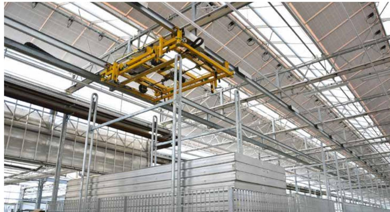
I bancali estraibili sono parte di un sistema di produzione definito "Container system" che prevede la gestione integrata della movimentazione e della logistica in serra.
