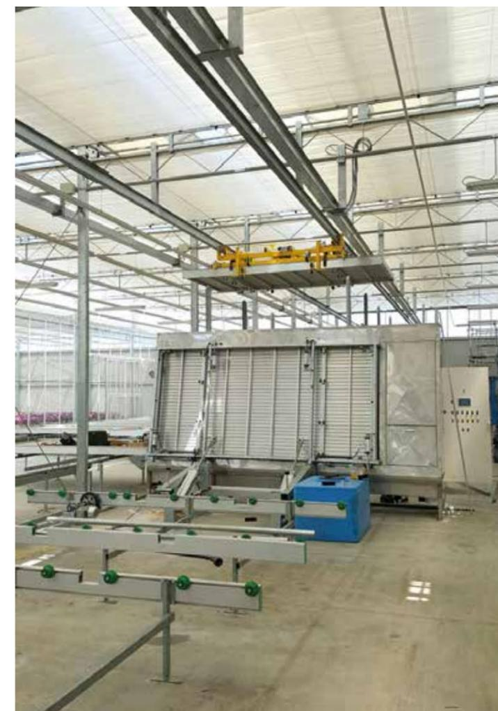
Nelle foto: esempi di impianti automatici di accatastamento e de-accatastamento di bancali estraibili con lavaggio e disinfezione automatica.
