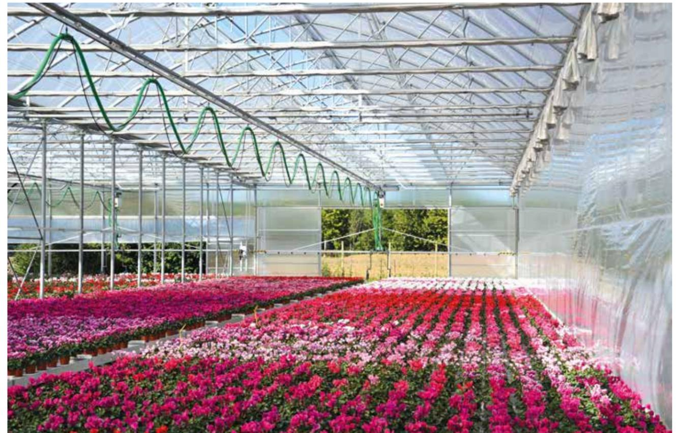
La barra a binario singolo è dotata di tubo per irrigazione avvolto in fascioni, la gomma che costituisce il tubo è in 4 strati (con pellicola interna ad uso alimentare, antitorsione, antialga, anti UV).
