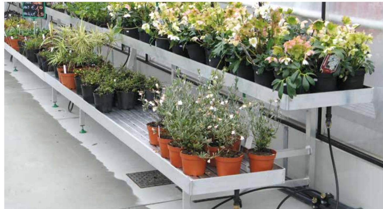
Le piramidi semplici a due o a tre piani sono costituite da bancaline in alluminio con profili di nostro esclusivo disegno. Il ripiano è in lega speciale Peraluman tipo IDROALU, sagomato per l'irrigazione flusso/riflusso. Le bancaline vengono saldate e sigillate presso la nostra officina. I sostegni sono in alluminio e possono essere dotati di piedino regolabile o di ruote.
