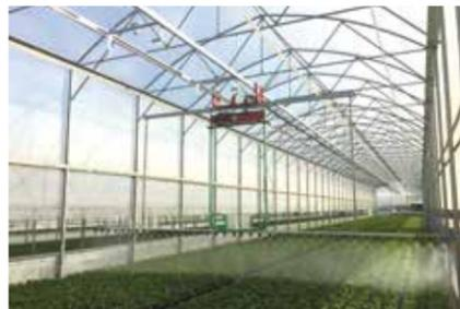
Barra di irrigazione, il doppio binario permette uno scorrimento più stabile anche per barre installate su serre molto alte.
