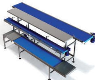
Modulo di disimballaggio dei vassoi di raccolta. Set di diversi nastri trasportatori, modulari e regolabili in altezza.
