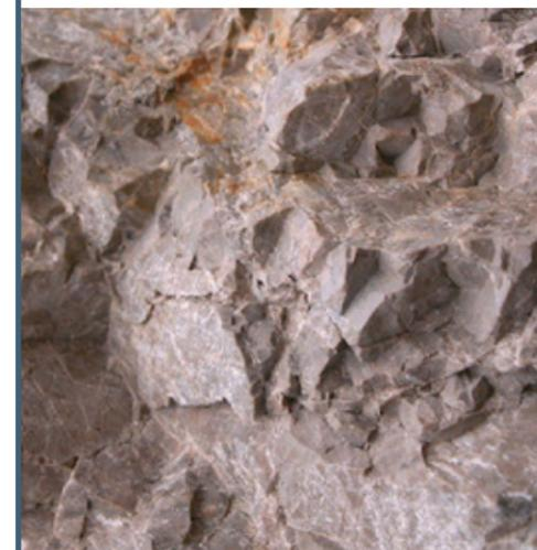
La roccia di cui è costituito il dedalo di gallerie delle Celle Ipogee è la dolomia, la stessa che sulle Dolomiti si tinge di rosa quando è colpita dai raggi solari. **La dolomia è una roccia sedimentaria carbonatica costituita dal minerale dolomite, un carbonato doppio di calcio e magnesio; si è formata nel Giurassico, circa 200 milioni di anni fa, quando la Val di Non era caratterizzata da scogliere marine.**
